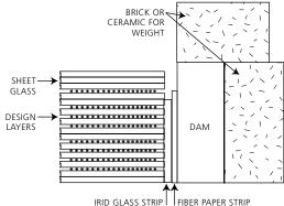
CROSS-SECTION OF SINGLE-FIRE STACK
