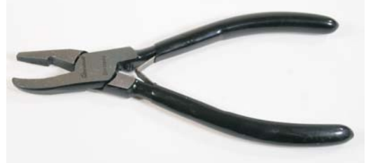
32 126 00 BOHLE Kröselzange, 160 mm Länge, 4 mm Backenbreite, kunststoffüberzogene Griffe, Kopf geschliffen, Rückstell feder für selbsttätiges Öffnen der Backen. Grozing pliers, 160 mm, 4 mm jaw width, plastic coated handles, ground head, with pull-back spring for automatic opening of the jaws.
