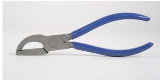
32 118 20 PROVETRO P410 (für / for 3 - 12 mm Glas / glass) Spiegeldickglasbrechzange, 185 mm Länge, 15 mm Backenbreite, ummantelter Griff / Breaking pliers for mirrors, 185 mm, 15 mm jaw width, coated grip
